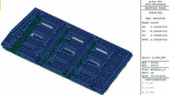
Figura 6. Reazioni vincolari alla base del modello in condizioni SLU strutturale in inviluppo.
