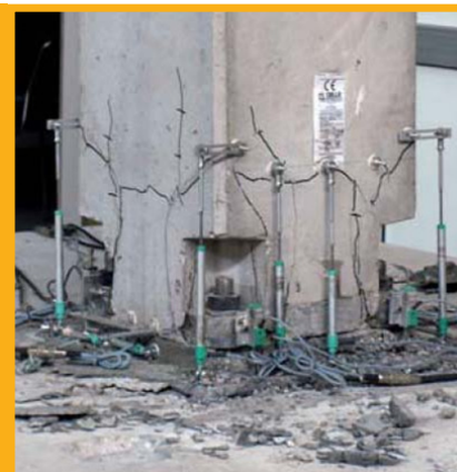
Figura 2. Curva di risposta taglio alla base - spostamento in sommità del provino sottoposto ad un carico assiale pari a 200 kN e relativo stato di danneggiamento a fine prova.
