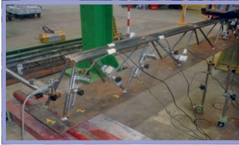
Figura 3: dettagli di una trave in fase di prova con flessimetri ed estensimetri
