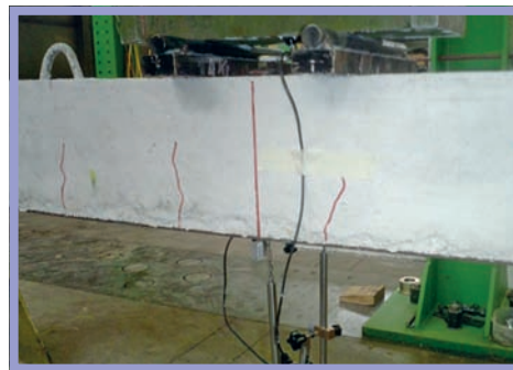
Figura 7: fessurazioni a rottura per flessione
